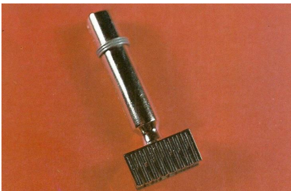
Punta especial de soldador destinada a circuitos integrados de doble fila paralela de patillas (Dual-in-line).
