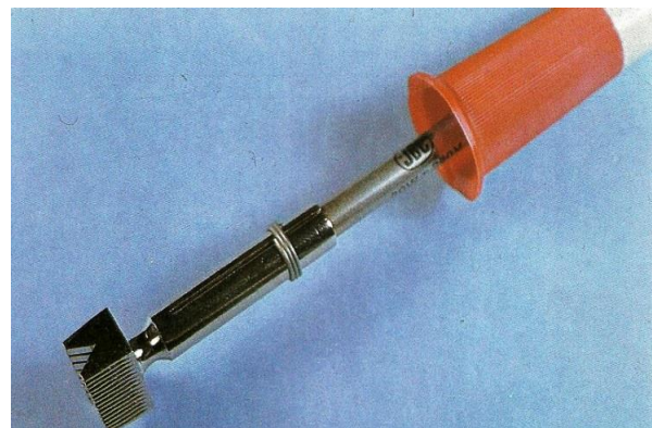
La punta anterior se instala sobre el soldador igual que cualquier punta convencional.
